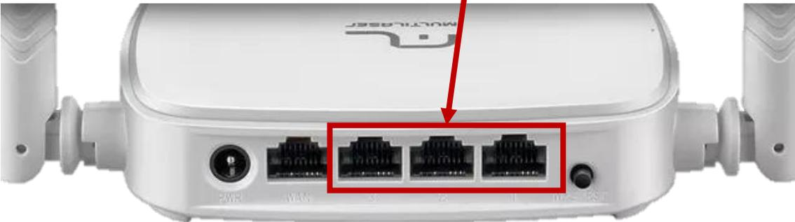
2º passo: Depois de conectar seu modem ao roteador, vamos conectar o seu computador em uma das entradas LAN do roteador utilizando um cabo de rede para isso, ou então conectar seu celular via Wi-Fi.
