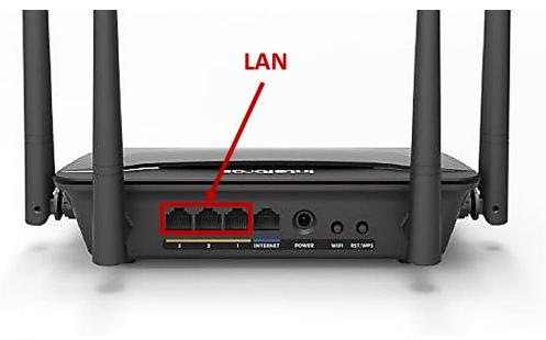
2º passo: Depois de conectar seu modem ao roteador, vamos conectar o seu computador em uma das entradas LAN do roteador utilizando um cabo de rede para isso, ou então conectar seu celular via Wi-Fi.
