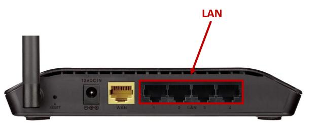
2º passo: Depois de conectar seu modem ao roteador, vamos conectar o seu computador em uma das entradas LAN do roteador utilizando um cabo de rede para isso, ou então conectar seu celular via Wi-Fi.
